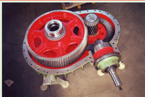
VISTA INTERNA RIDUTTORE DELLE SPEEDMULLOR SERIE "B"
