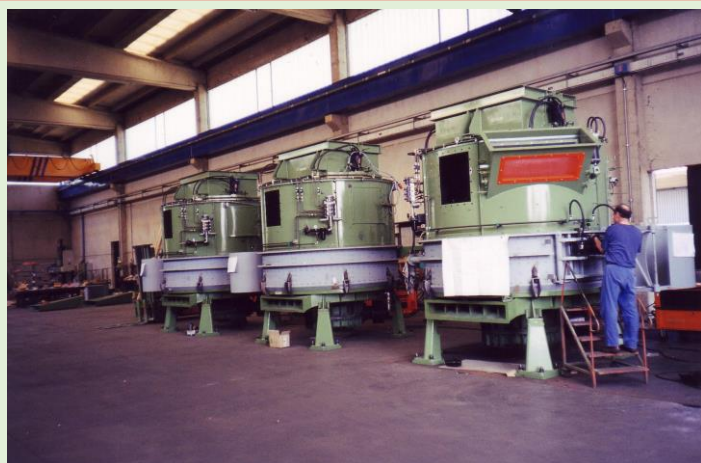
COSTRUZIONE DI PIU' MESCOLOTRICI
