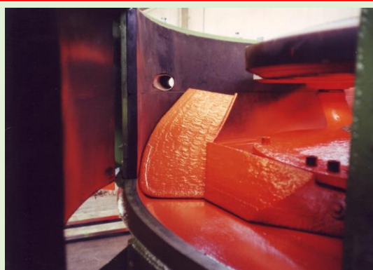
VISTA INTERNA DI UNA SPEEDMULLOR CON FORO INGRESSO INIEZIONE ADDITIVI
