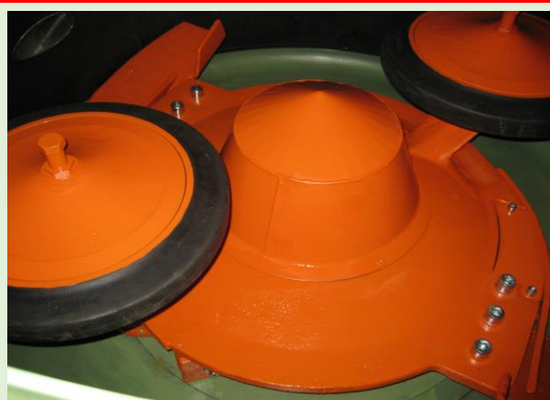
VISTA INTERNA DI UNA PICCOLA SPEEDMULLOR CON RUOTE MOLAZZANTI
