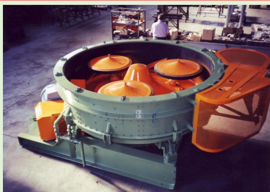
VISTA INTERNA DI UNA SPEEDMULLOR CON RUOTE MOLAZZANTI
